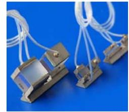
我公司提供的 RTP 晶体 Q 开关, 采用双晶体结构, 两块晶体光轴彼此垂直, 可以自动补偿环境温度变化, 是一种无需温控的激光器件。除此之外, RTP 晶体器件还具有下列明显优势:
